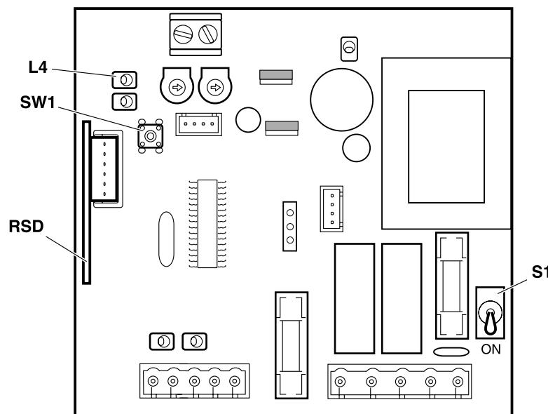
☞ Používáte-li vysílač stálého kódu (433,92MHz či 868,35MHz) a přijímač RSD-433 (433,92MHz) nebo RSD-868 (868,35MHz), můžete nahrávat rádiový kód přímo do skříně řídící jednotky podle postupu, který následuje. V ostatních případech se držte pokynů přiložených k přijímači, který používáte.
