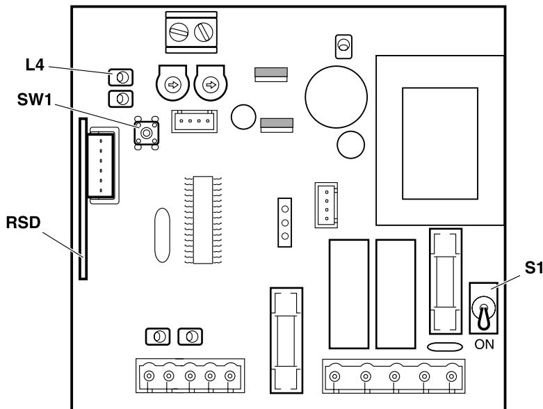
☞ Если используется передатчик с фиксированной частотой (433,92 МГц или 868,35 МГц) и подключаемый приемник RSD-433 (433,92 МГц) или RSD-868 (868,35 МГц), можно зарегистрировать радиосигнал с помощью самой панели управления описанным ниже способом. В остальных случаях следуйте инструкциям к используемому подключаемому приемнику.
