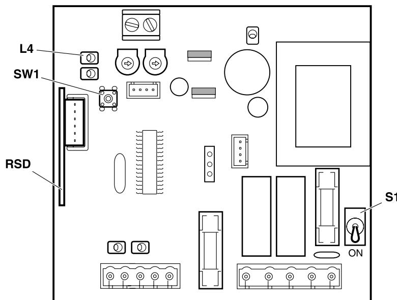
☞ Si des émetteurs à Code Fixe sont utilisés (433,92MHz ou 868,35MHz) ainsi que le récepteur enfichable RSD-433 (433,92MHz) ou RSD-868 (868,35MHz), il est possible d'enregistrer le code radio dans l'armoire de commande, tel que cela est expliqué ci-dessous. Dans les autres cas, suivez les instructions du récepteur enfichable que vous utilisez.
