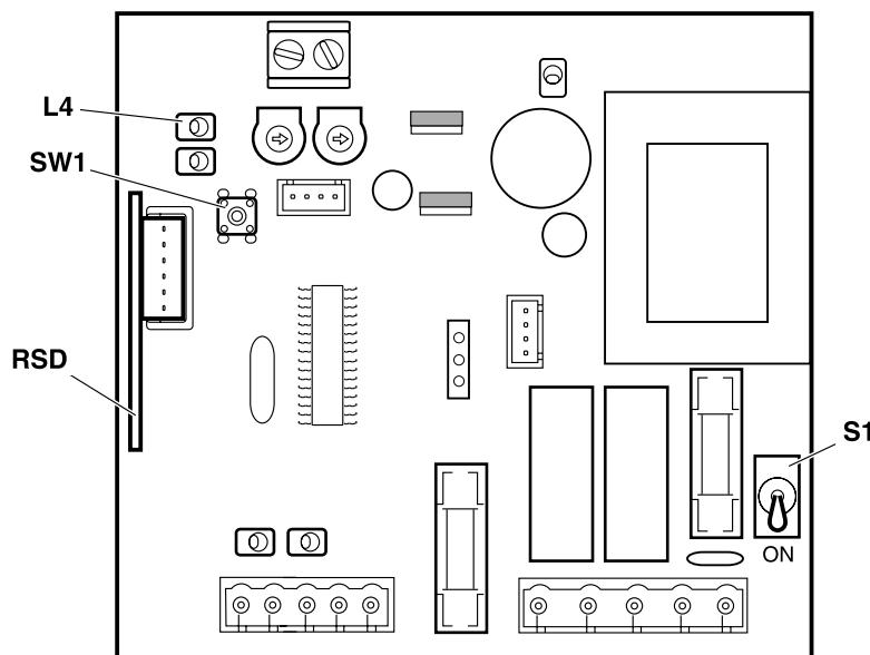
Se utilizar emissores de Código Fixo (433,92 MHz ou 868,35 MHz) e o receptor contactável RSD-433 (433,92 MHz) ou RSD-868 (868,35 MHz), pode gravar o código de rádio no próprio quadro de manobra, tal como é explicado a seguir. Nos outros casos, siga as instruções do receptor conectável que utilizar.
