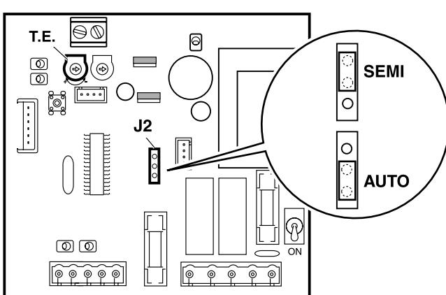
El modo de funcionamiento se selecciona mediante J2:
