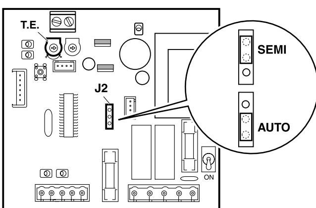
Le mode de fonctionnement est sélectionné avec J2 :
