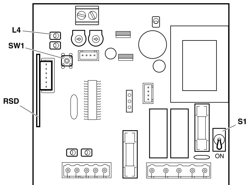
Dacă utilizați emițătoare cu Cod Fix (433,92MHz sau 868,35MHz) și receptorul conectabil RSD-433 (433,92MHz) sau RSD-868 (868,35MHz), puteți înregistra codul radio la panoul de comandă, după cum urmează. În celelalte cazuri, respectați instrucțiunile receptorului conectabil pe care îl utilizați.
