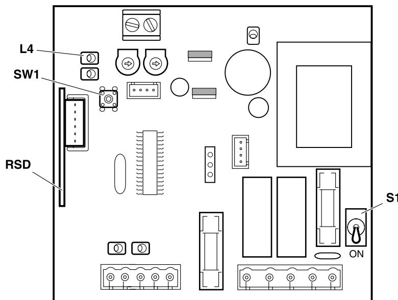
☞ Si utiliza emisores de Código Fijo (433,92MHz o 868,35MHz) y el receptor enchufable RSD-433 (433,92MHz) o RSD-868 (868,35MHz), puede grabar el código de radio en el propio cuadro de maniobra, tal como se explica a continuación. En los demás casos, siga las instrucciones del receptor enchufable que utilice.
